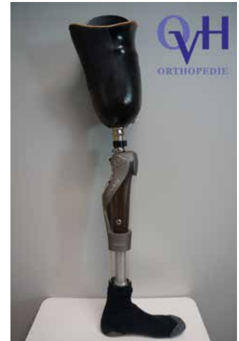
Figure 1 Prothèse fémorale (fût en carbone - genou électronique C-Leg)
