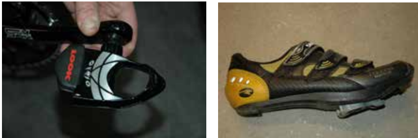
Figure 11 - Pédales de sécurité.
